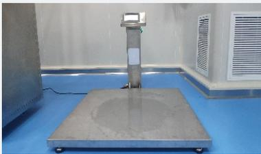
车间工序损耗率精准核算，通过读取周转器具的RFID以及自动称重，实现工序的数据自动核算，并实施反馈给上层系统。
