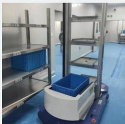
多层货架AGV可实现系统自动齐套备料、货位识别，并递送货物到相应的功能区，能有效取代人工搬运与备料的工作。AGV运行数据可实时联网，实现运行状态实时监控、自动充电管理等功能。
