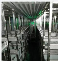
通过与步科WMS和WCS仓库管理软件配合使用，能有效解决物料和成品的实时管理，保障先进先出。设备支持在-18℃低温环境下运行，大幅降低人工成本的同时，也可以保障仓库的无人化管理。
